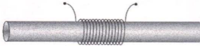
La Fig. 1 muestra este principio empleado para calentar un cilindro metálico o "billet"
